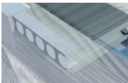
3 AntiDUST® tape und U-Profil Zur Abdichtung der offenen Paneeelseiten. Die Variante mit Filter gehört an das untere Plattenende, damit das Kondenswasser ablaufen kann.
