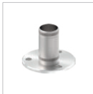
Wand- & Bodenanker, zum Einschlagen ins Rohr für Rundrohre, zum Einschlagen, mit Rändelung, geschliffen K240
