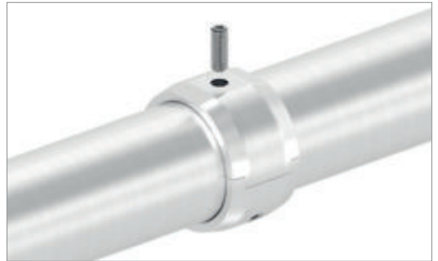
4. SCHRITT: Gewindestift oben eindrehen. Empfehlung: Gewinde in das bestehende Handlaufrohr einschneiden und Schraube etwas eindrehen.
