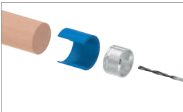
1. SCHRITT: Bohrlehre (50606-240) auf den Holzhandlauf setzen und den Adapter (50605-240) in die Bohrlehre schieben.
