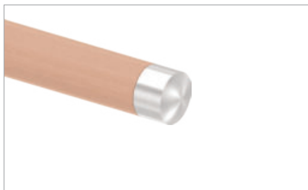
6. SCHRITT: Endcappe aufsetzen und Metallkleber aushärten lassen.
