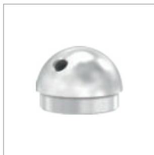
Rohrabschlusstopfen halbrund, mit Innengewinde 45° aus Vollmaterial, zum Einschlagen, mit Rändelung, geschliffen K240
